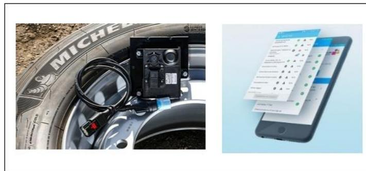
輪圈加裝感測器以及EFFITIRES輪胎管理系統
